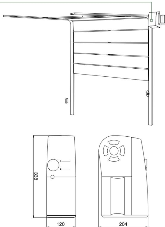
**NB.** Per porte sezionali superiori a 22 mq e fino a 34 mq necessita uso del kit VISCH.
