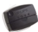
Ricevitore radio a 1 canale e memoria integrata di 750 codici. Uscita a morsettiera con 1 relè NO a quattro modalità di funzionamento: monostabile, bistabile, temporizzazione 30 sec. e temporizzazione 180 sec. Ingresso antenna e alimentazione 12÷24V a.c./d.c.
