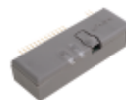
Ricevitore radio a 2 canali su frequenza 433,92 MHz. Memoria integrata di 1000 codici. Modulo a innesto. Codifica LIFE Rolling Code e Auto Code.
