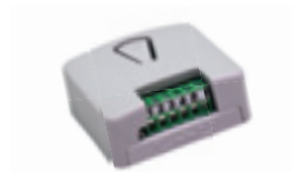
Ricevitore radio a 1 canale e memoria integrata di 30 codici. Uscita a morsettiera con 1 relè NO a quattro modalità di funzionamento. Ingresso antenna e alimentazione 12÷24V a.c./d.c.
